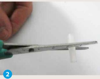
**Schneide** den Silikon-Kupplungsschlauch in zwei 5 mm lange Teile.
