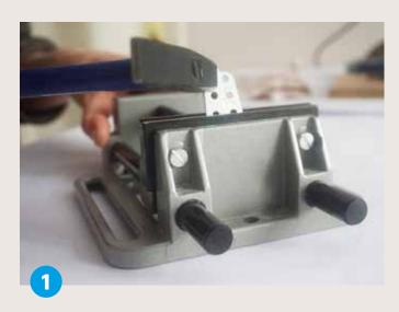
**Biege** die zwei Metall-Lochstäbe am dritten Loch um, so dass eine Ecke entsteht (90 Grad). Du kannst einen Maschinenschraubstock und einen Hammer benutzen.
