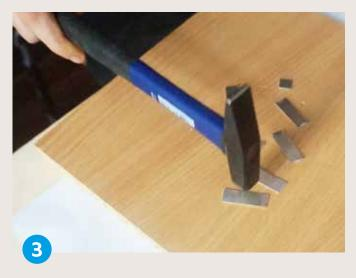
**Entgrate** sie und schlage sie mit dem Hammer glatt.
