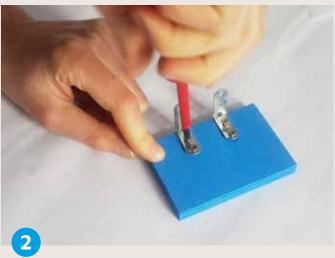
**Schraube** die Lochstäbe mit den Spaxschrauben an den Solarständer K.
