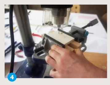
Gehe zur Tischständerbohrmaschine, spanne das Brett im Maschinenschraubstock ein. **Bohre** mit dem Ø 2 mm Bohrer alle 4 Löcher.
