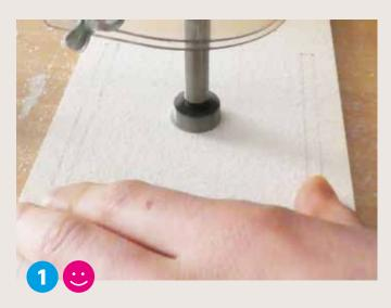
Gehe mit deiner Grundplatte an die Tischständerbohrmaschine. **Bohre** mit einem Ø 20 mm Bohrer die zwei Bohrungen für die Aussparung.
