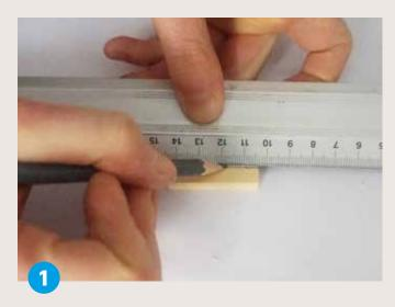
Nimm das Holzteil und **zeichne** mithilfe eines Lineals eine Mittellinie auf der Längsseite. Sie soll **12 mm** lang sein.
