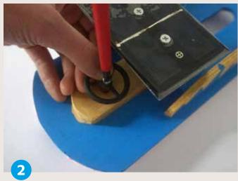
Nehme eine Zylinderkopfschraube M4x20 mm. **Befestige** das Lenkrad an dem Teil E in der Bohrung Ø 3,5 mm.
