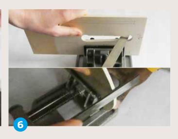
**Entgrate** und **schleife** alle gesägten Kanten mit einer Feile oder Schleifpapier.
