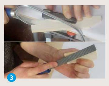
Säge die Teile D, E und F aus. Entgrate die Kanten mit der Feile oder mit Schleifpapier.
