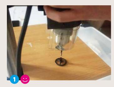
Gehe zur Ständerbohrmaschine und **bohre** mit einem Ø 4 mm Bohrer das Lenkrad durch.
