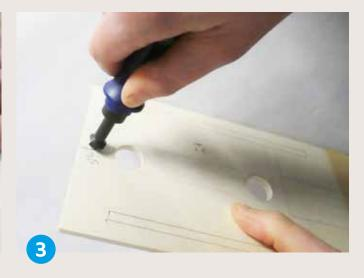
**Entgrate** die beiden kleinen Bohrungen mit dem Handsenker. Dadurch werden die Ränder der Löcher glatt gemacht.
