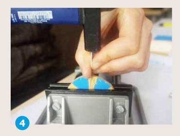
Spanne das Holzrad in den Maschinenschraubstock ein.
