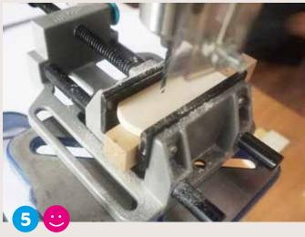
Gehe an die Bohrmaschine, spanne das jeweilige Teil in den Maschinenschraubstock ein und **bohre** in beide Teile E Ø 3,5 mm Löcher.
