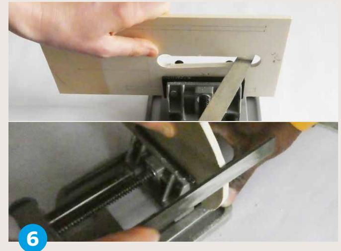
**Entgrate** und **schleife** alle gesägten Kanten mit einer Feile oder Schleifpapier.
