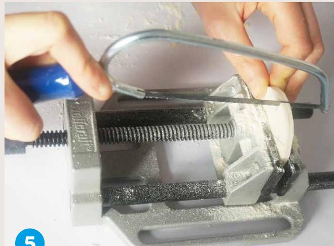
**Säge** die 6 Einschnitte für die Schaufeln 10 mm tief.
