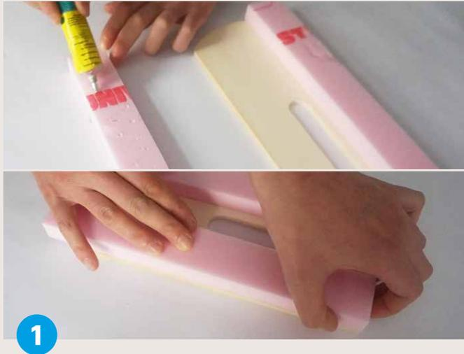
**Klebe** die zwei Teile mit Styroporkleber an und drücke sie ca. zwei Minuten fest. Achte darauf, dass sie vorne bündig sind. Beschwere sie mit einem schweren Gegenstand, um sie anzudrücken.
