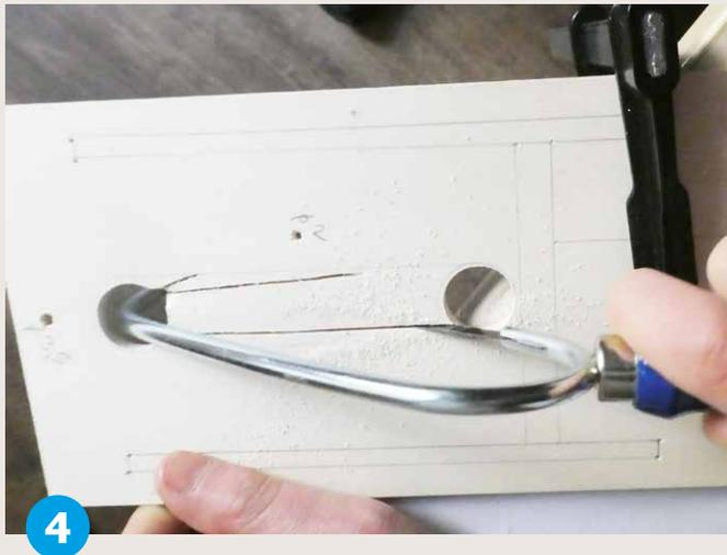
**Säge** die Aussparung mit der Feinsäge aus.
