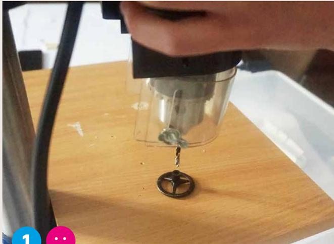
Gehe zur Ständerbohrmaschine und **bohre** mit einem Ø 4 mm Bohrer das Lenkrad durch.
