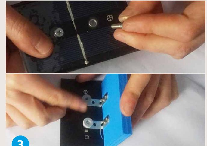
Danach **stecke** das Solarmodul mit zwei Senkkopfschrauben an das Lochblech.
