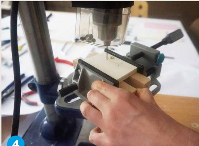
Gehe zur Tischständerbohrmaschine, spanne das Brett im Maschinenschraubstock ein.
