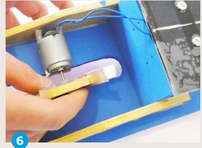
**Stecke** den Motor in die Halterung und stecke das Schaufelrad auf die Welle.
