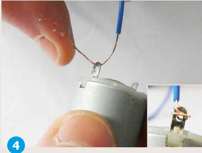
**Montiere** den Schaltdraht am Solarmotor und schiebe die Silikonschläuche auf die Motorklemmen.
