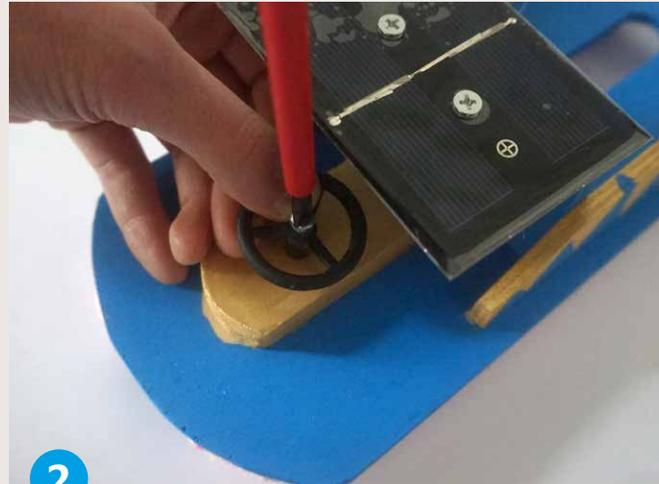
Nehme eine Zylinderkopfschraube M4 x 20 mm. **Befestige** das Lenkrad an dem Teil E in der Bohrung Ø 3,5 mm.
