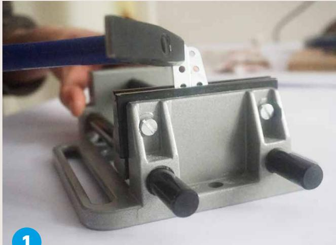
**Biege** die zwei Metall-Lochstäbe am dritten Loch um, so dass eine Ecke entsteht (90 Grad). Du kannst einen Maschinenschraubstock und einen Hammer benutzen.
