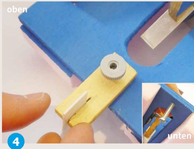
**Schraube** das Holzteil mit einer Zylinderkopfschraube auf der Grundplatte von unten fest und befestige es von oben mit der Rändelmutter M4.
