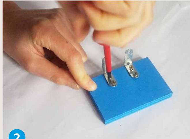
**Schraube** die Lochstäbe mit den Spaxschrauben an den Solarständer K.
